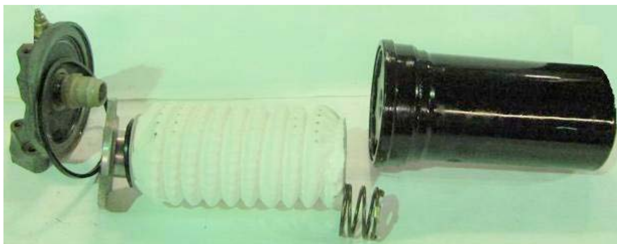
Рисунок 3.3.84 Состав масляного фильтра
