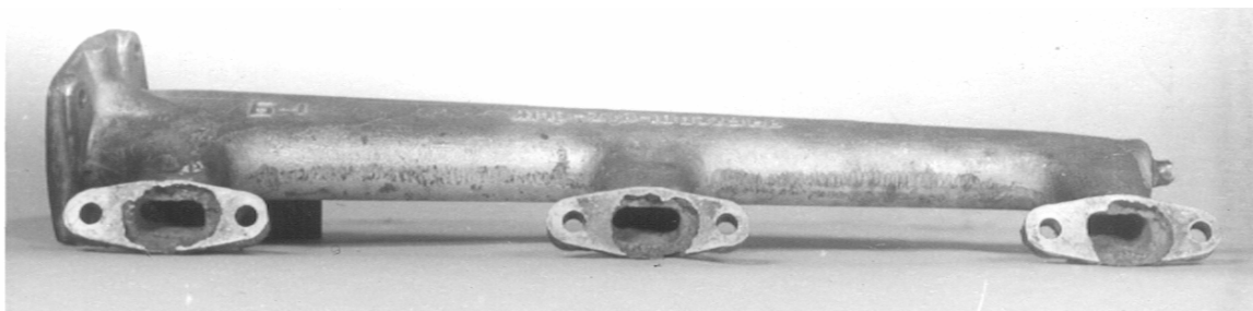
Рисунок 3.15 - Труба водяная. Разрушение стенок фланцев
