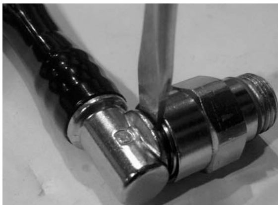
Рис.3.3.7 Снятие наконечников трубок низкого давления с фитингов
