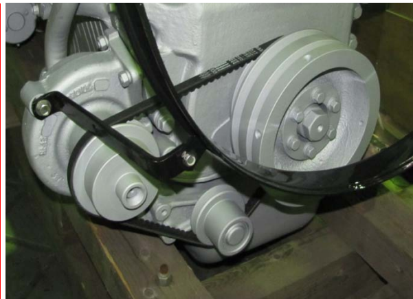
Рисунок 3.1 - Регулировка натяжения ремня привода водяного насоса
