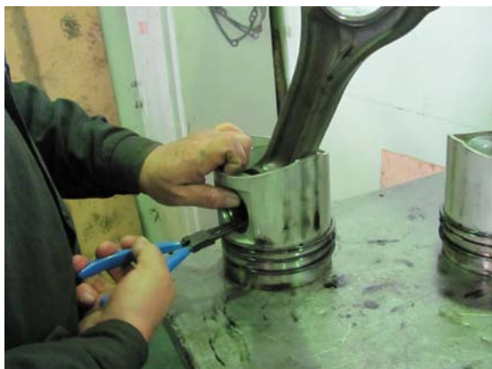
Рис.3.3.72 Снятие стопорных колец
