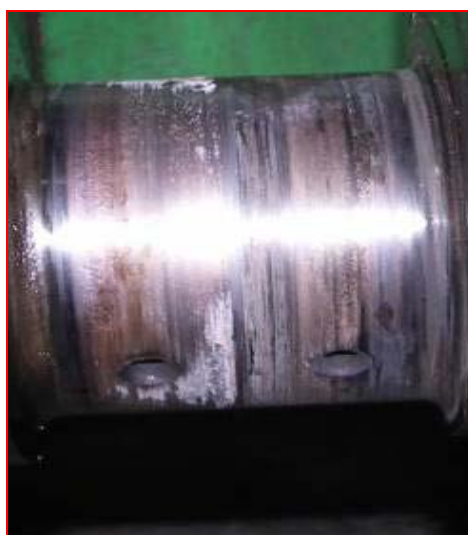
Рисунок 3.12 Задир шейки вала
