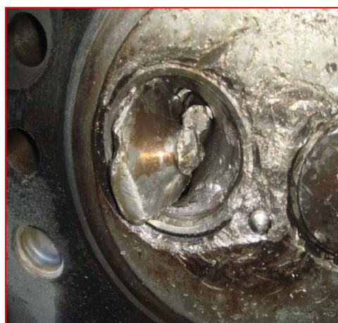
Рисунок 3.8 Разрушение головки цилиндров и клапана
