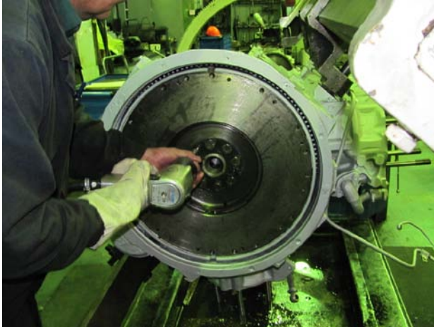
Рис.3.3.40 Отвернуть болты крепления маховика
