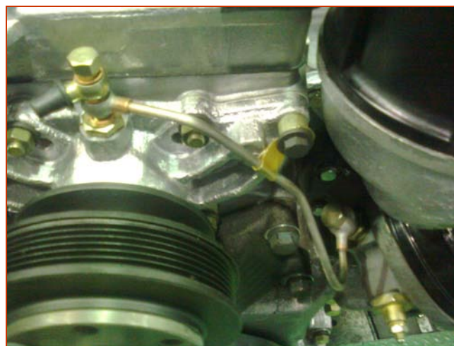
Рисунок 4.33а Установка трубки подвода масла к приводу вентилятора
