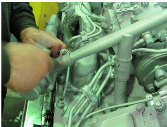
Рис.3.3.16 Снятие тройника системы байпаса
