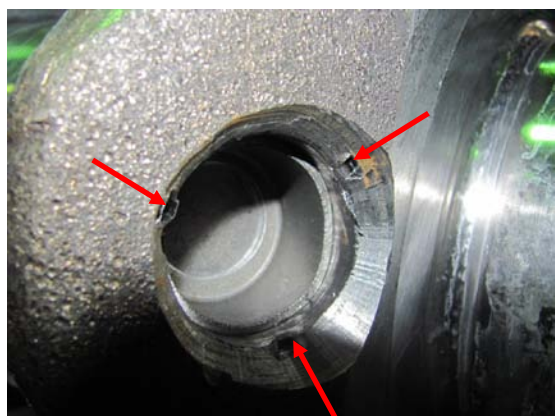
Рис.4.9 а - Раскерновка для фиксации заглушки
