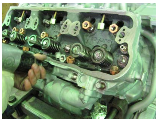
Рис.3.3.51 Отвернуть гайки. Снятие головки цилиндров.
