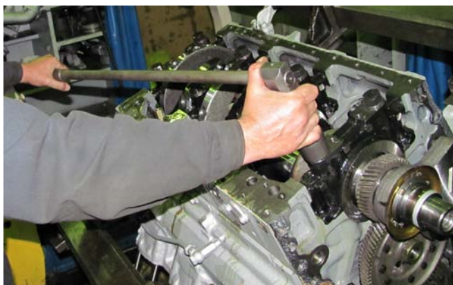
Рис.3.3.58 Ослабить затяжку болтов крепления крышек коренных подшипников
