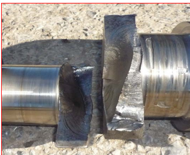
Рисунок 3.11 Слом коленчатого вала
