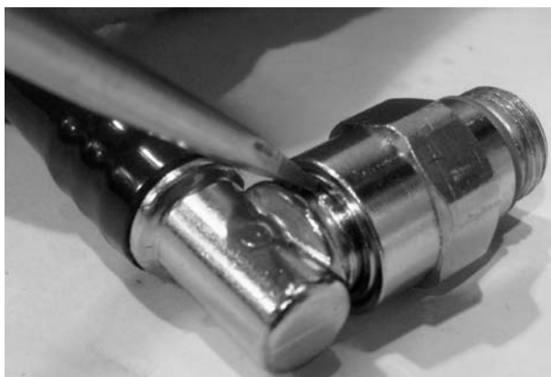
Рис.3.3.7 Снятие наконечников трубок низкого давления с фитингов
