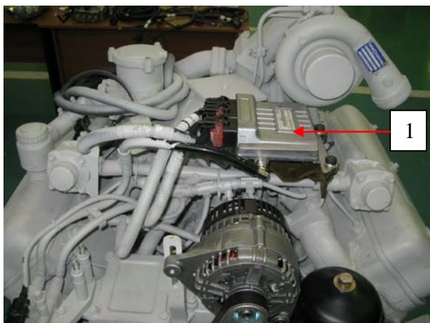
Рис.3.3.6 Снятие жгутов на ЭБУ.
