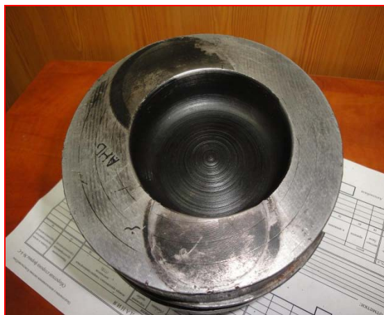
Рисунок 3.10 Контакт клапана с поршнем
