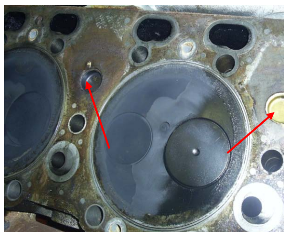
Рисунок 3.5 Перегрев головки цилиндров - заглушки полостей охлаждения меняют цвет
