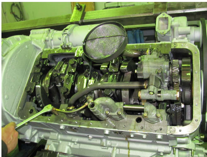
Рис. 4.29 а – Установка дифференциального клапана и соединительной трубки
