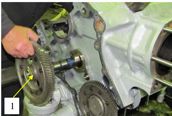
Рис.3.3.65 Снятие, извлечение распредвала из блока
