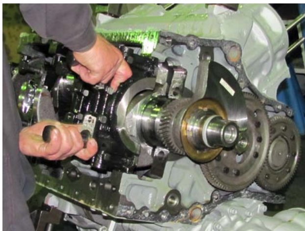
Рис.3.3.60 Снятие крышек коренных подшипников
