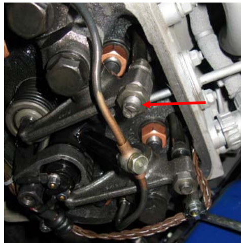
Рисунок 3.6а Регулировка зазора из-за износа ролика толкателя
