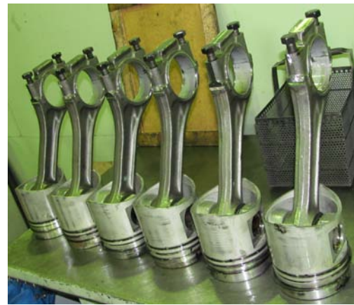
Рис.3.3.55 Установка крышек шатунов
