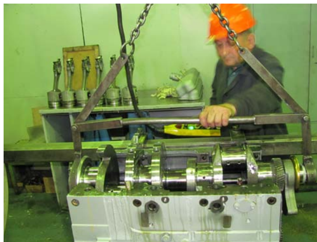
Рис.3.3.61 Снятие коленчатого вала
