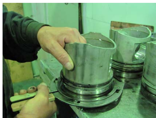
Рис.3.3.73 Снятие поршневых колец
