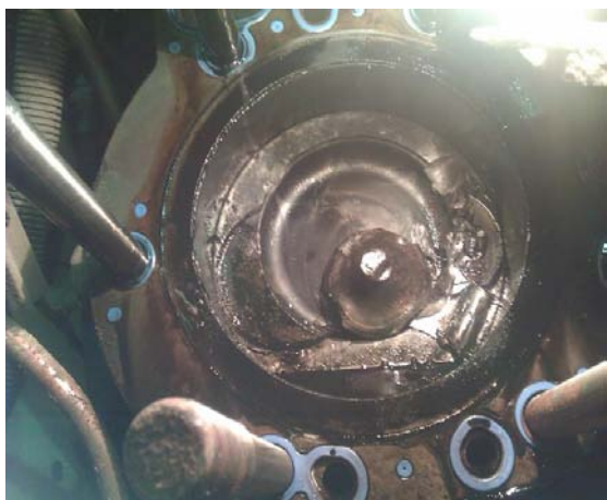
Рисунок 3.9 Обрыв головки клапана
