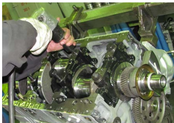
Рис.3.3.59 Отвернуть болты крепления крышек коренных подшипников
