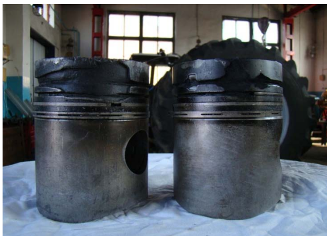
Рисунок 3.7 Прогар перемычек поршня
