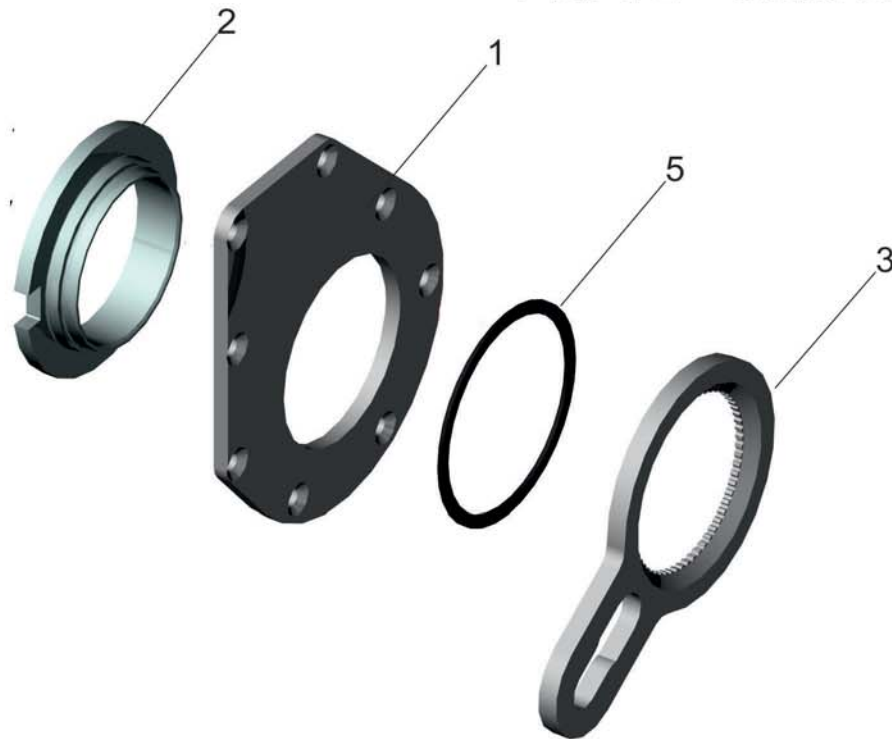
Рис. 72 Привод управляющий 64226-3501166 Fig. 72 Control drive 64226-3501166
